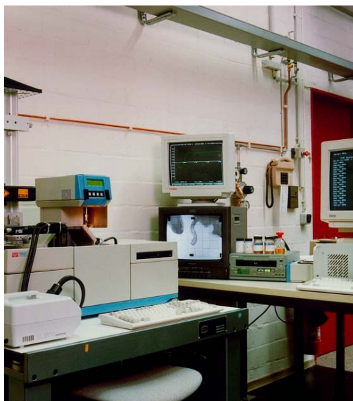
Modifizierte Benetzungswaage mit Video- kontrolle
